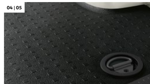
03 Betonplex vloerplaat 9 of 12 mm. 1), 7) Beschermt de bodem en biedt tevens de ideale basis voor het achteraf inbouwen van verschillende soorten kastsystemen. Bestaat uit 9 of 12 mm dik fins berkentriplex afgewerkt met een harde anti slip toplaag met cirkelmotief. Voorzien van verzonken sjoorrog kommen. | BW |
