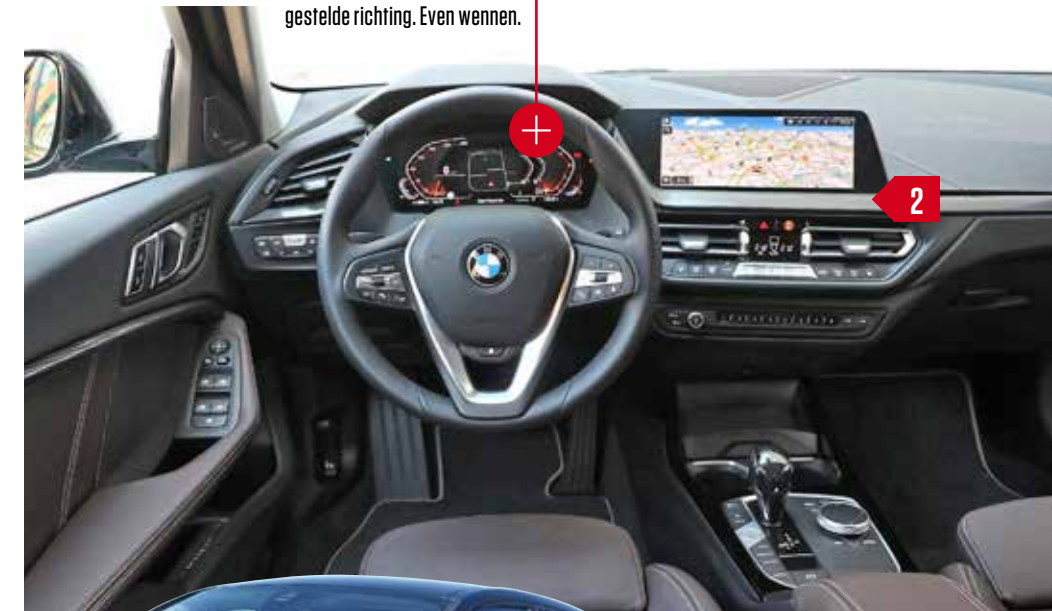
De toerenteller 'draait' in tegengestelde richting. Even wennen.
